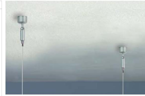
**IT** tirante snodabile per cavi, sistema autobloccante. fissaggio a soffitto universale per cavi di acciaio o nylon. montare il tirante a soffitto e inserire il cavo nel morsetto. il meccanismo di autobloccaggio trattiene automaticamente il cavo. fissaggio: tirante per cavi, sistema autobloccante, snodabile, montaggio a soffitto o a parete. materiale: ottone color argento. distanza dal soffitto: 49mm. spessore cavo: max. Ø2mm.
