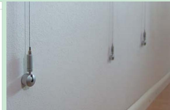
**IT** tirante snodabile per cavi, sistema variabile. montare il tirante ed inserire il cavo: il sistema di autobloccaggio lo trattiene automaticamente. la tensione del cavo si regola avvitando la parte snodabile del tirante. fissaggio: tirante per cavi, sistema autobloccante in tensione, snodabile, per soffitto e parete. materiale: ottone color argento. spessore del cavo: max. Ø2mm.
